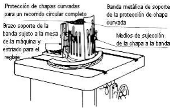
Trabajos en piezas curvadas con anillo de apoyo
