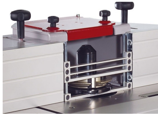
Protección de parte no activa de la herramienta de corte
